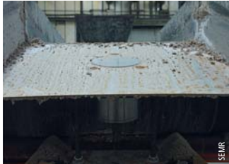
Photo 3 Vue de la sonde encastree à la sortie du tapis apres essai View of probe embedded at belt discharge after test
