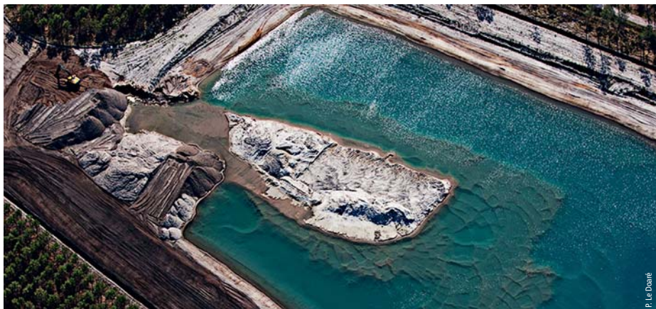
Photo 3 Emprunt de sables des Loudes par exploitation sous eau Water retention basin
