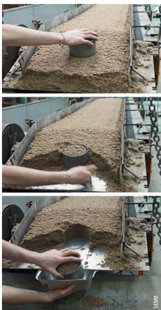
Photo 4 Prélèvement matière à partir duquel est réalisée la teneur en eau réelle Sampling of material on which real water content is based
