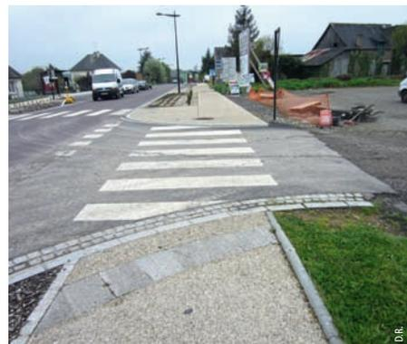
Les passages piétons sur plateaux surélevés sont de plus en plus courants afin de ralentir les véhicules et de supprimer tout dénivelé entre les deux côtés de la chaussée traversée. Cet aménagement est appelé « trottoir traversant » en absence d'un marquage pour piéton et il est une continuité du trottoir sur la chaussée.
