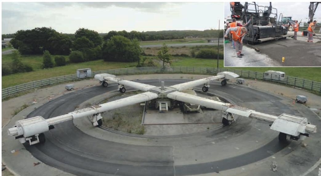
Le manège de fatigue de l'IFSTTAR et vue de la construction des structures Recyroute
