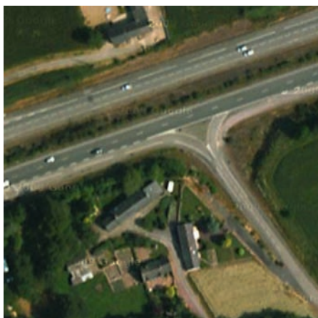
Photo 3 Alignement avec carrefour en T Imagerie© 2013 TerraMetrics, données cartographiques©2013 Google Alignment with T intersection
