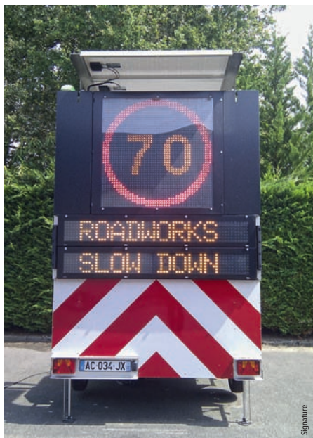
PMV mobile Optifib avec afficheurs et pictogramme certifié CE, radar de vitesse à lecture de plaque, alimentation hybride, photovoltaïque + groupe thermique, permettant une autonomie moyenne de 8 jours Optifib mobile VMS with displays and pictogram, CE certified, licence plate reading speed radar, hybrid power supply, photovoltaic + heat engine, with self-contained capacity of 8 days
