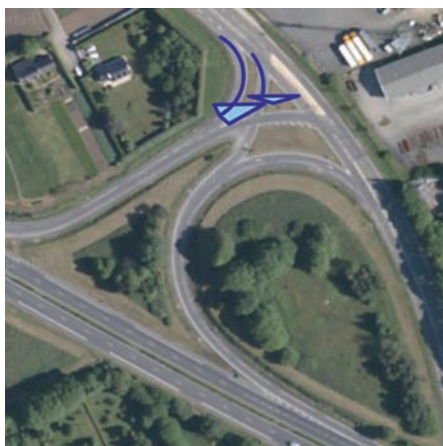
Photo 4 Confusion entre deux bretelles Imagerie© 2013 TerraMetrics, données cartographiques©2013 Google Confusion between two ramps
